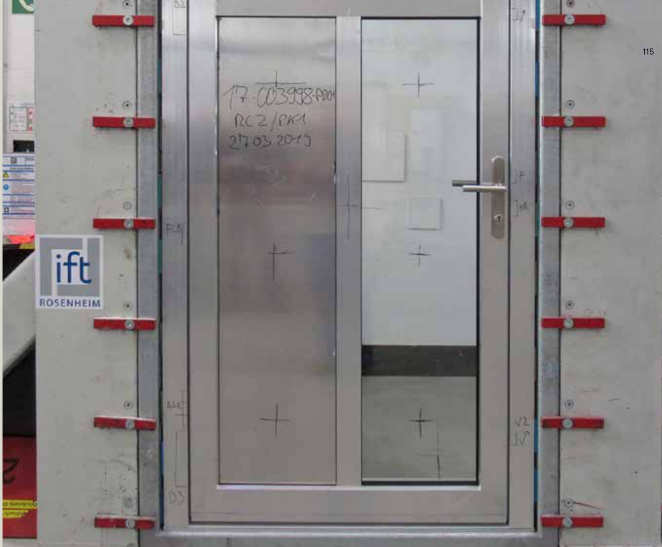
Op de testlocatie onderzoekt het Institut für Fenstertechnik (ift) Rosenheim de inbraakbeveiliging van huisdeuren.
