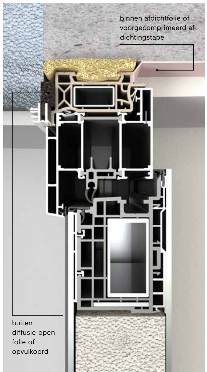
Tweetraps montage met stelkozijn
