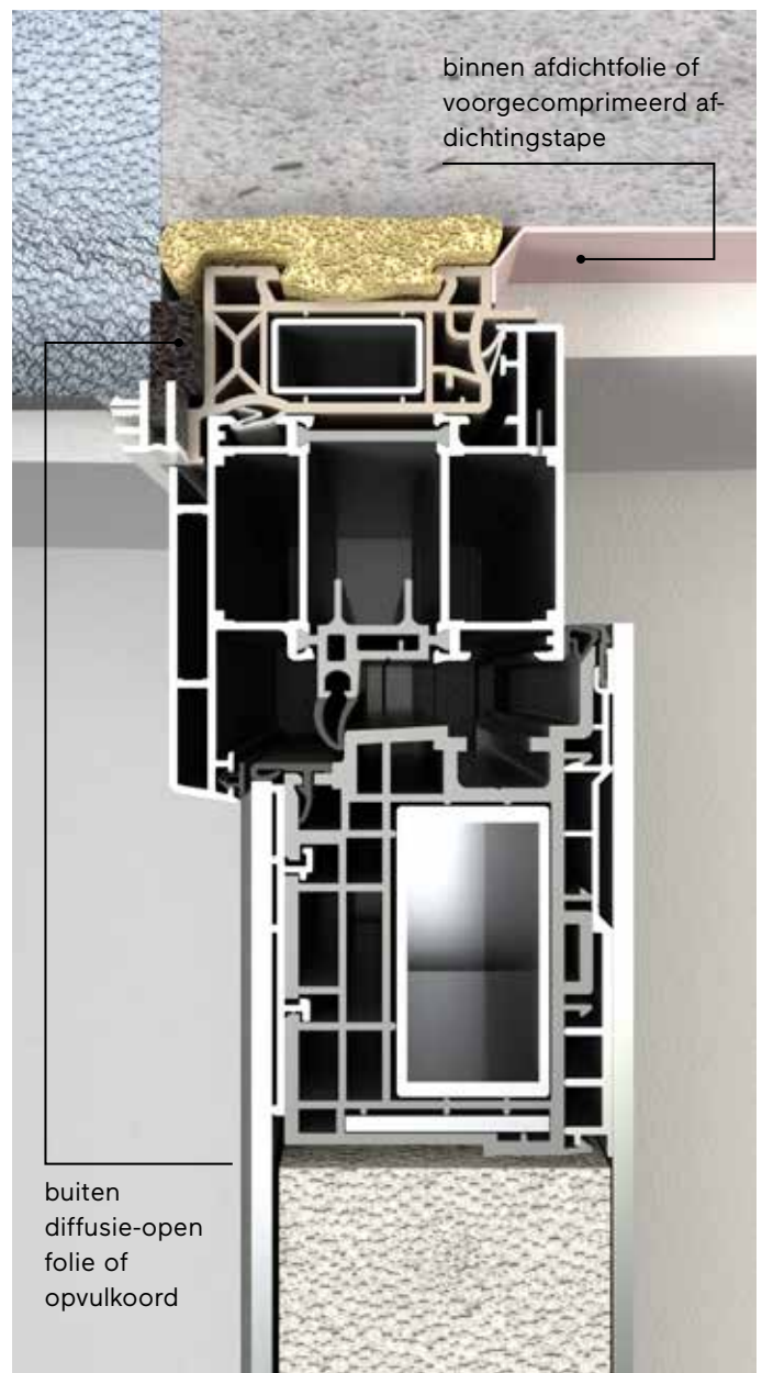
Tweetraps montage met stelkozijn
