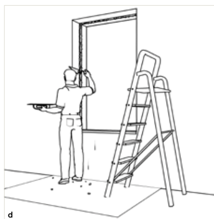
d De dagkant wordt van buiten en van binnen hersteld (stucen en schilderen). Indien nodig wordt een steiger gebruikt.
